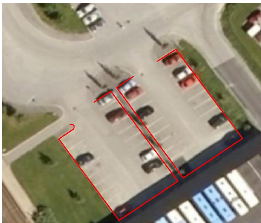
Figur 27: Eksempel på AnnetVegarealAvgrensning (tegnet med rød strek).
