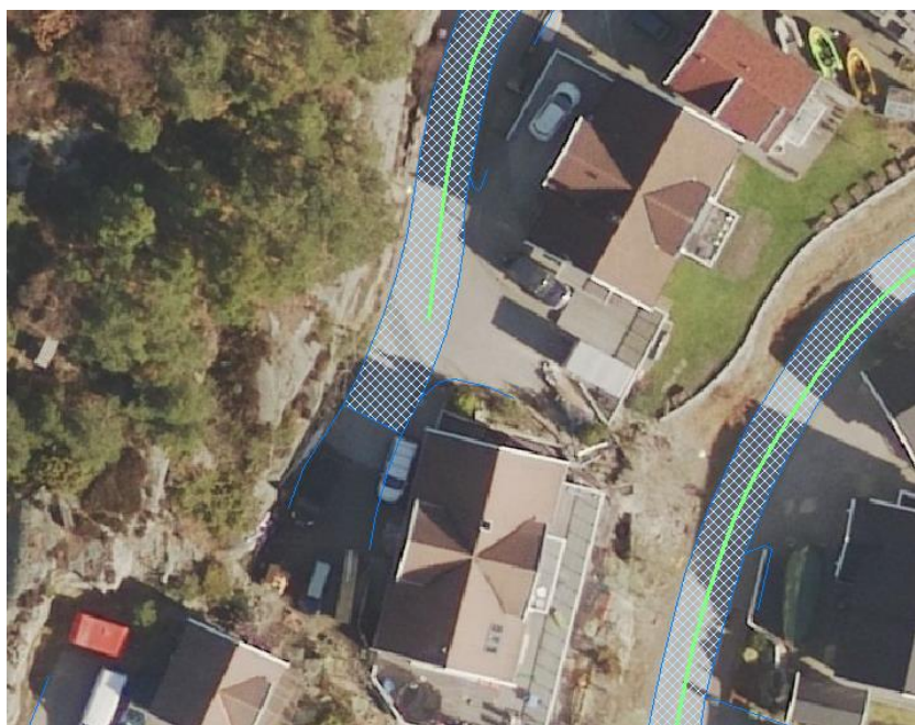
Figur 17: Eksempellet viser et godkjent avvik (under 10m) mellom FKB-Vegnett (grønt) og FKB-Veg (flate med skravur). Det er ikke krav om å slette del av vegflaten som strekker seg lenger enn veglenka.
