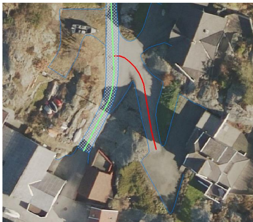
Figur 15: Eksempelen viser en Veglenke (rødt) i FKB-Vegnet som er kortere enn 50 m som ikke skal slettes (selv om den ikke oppfyller kriteriene for fotogrammetrisk registrering) ettersom vegen fortsatt eksisterer og er kjørbær i bildene. I dette tilfellet skal det ikke registreres vegflate i FKB-Veg (inkonsistens mot Vegnet tolereres).
