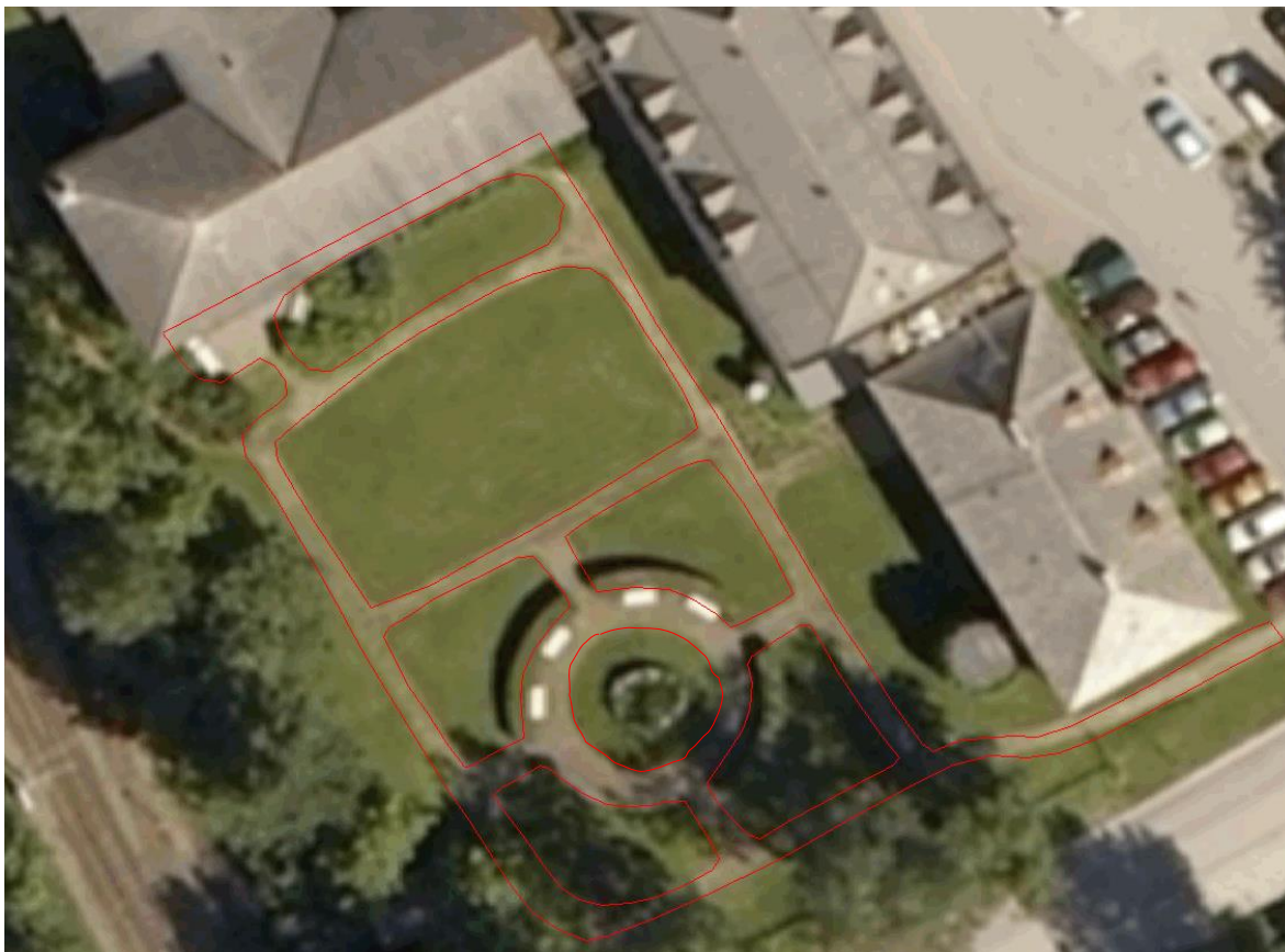
Figur 41: Eksempel på registrering av Gangvegkant i en park (rød strek).
