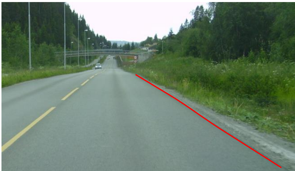
Figur 4: Eksempel på registrering av Vegdekkekanth (asfaltkanten registreres – rød linje).
