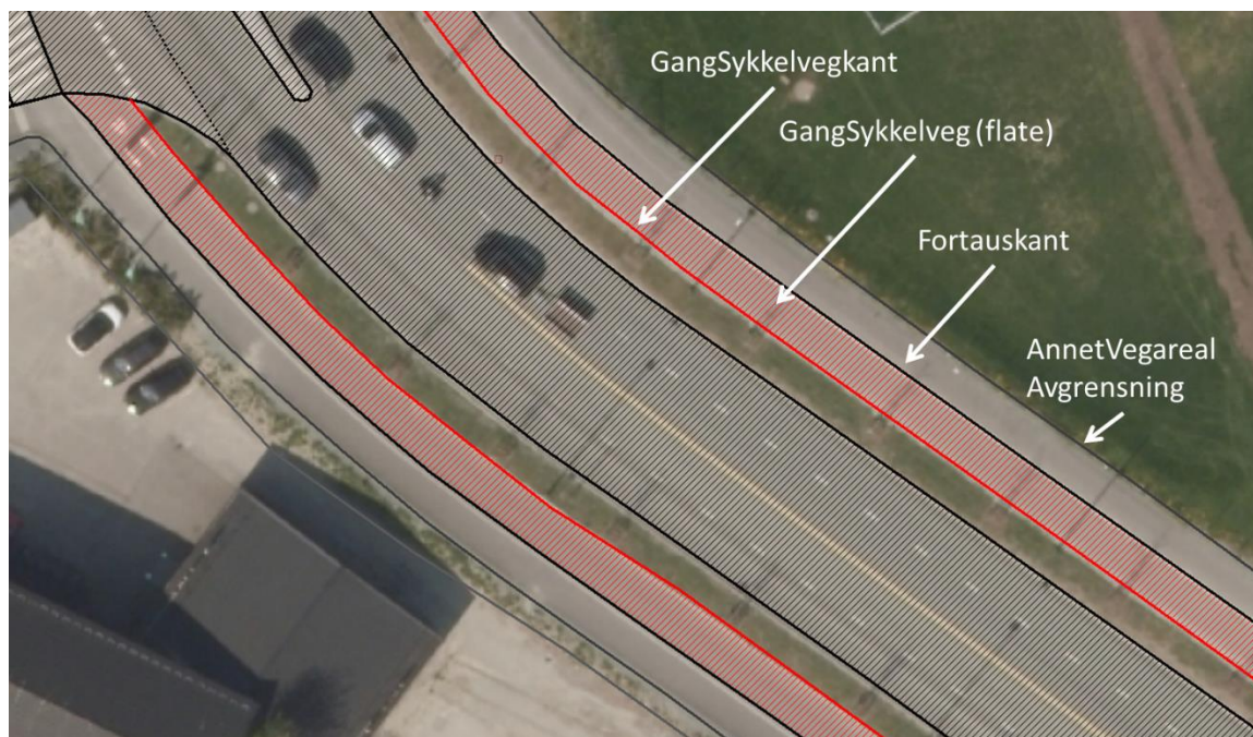
Figur 36: Eksempel på registrering av GangSykkelveg langs fortau.
