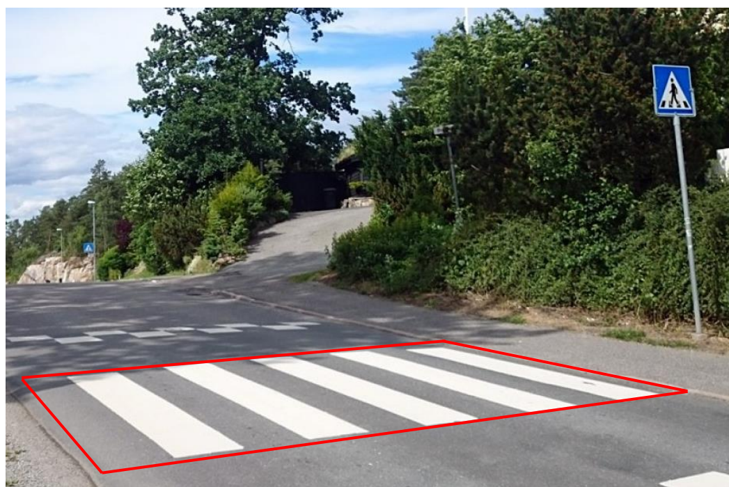
Figur 40: Eksempler på registrering av GangfeltAvgrensning (rød strek).
